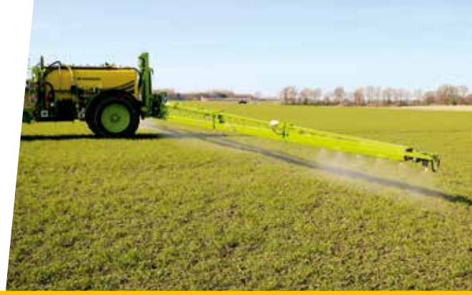
Direkteinspeisung im Praxistest. Eine Drohne erfasst zuvor Unkrautdichte und -arten.
