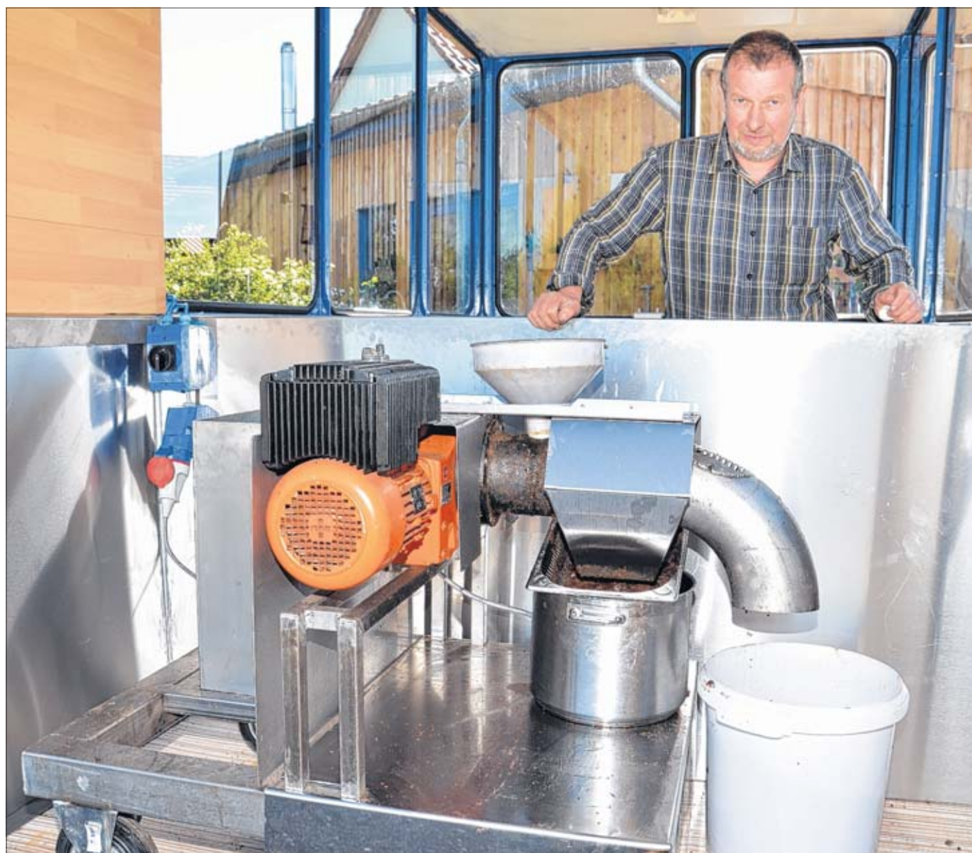
Ernst-Adolf Kampe an seiner Ölmühle Marke Selbstkonstruktion, die Leinöl kalt presst. Der Landwirt aus Parchen setzt auf eine „gläserne Produktion“. Fotos (2): Simone Pötschke
